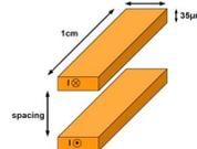
Fig. 14: Busbar geometrical parameters
