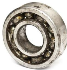
Figure 1: Roulement à billes avec défaut
